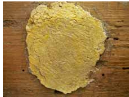
Сл. 6,2; 6,3; 6,4. Три слоја на бел малт̀ер (коноит̀ени влакна, ѝесок и фин ѝовршински слој жолт̀о обоен) Fig. 6, 2; 6, 3; 6, 4. Three layers of white mortar (rope fibers, sand, and fine yellow colored upper layer)
