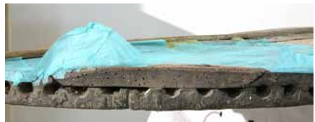
Сл. 16. Лежиѕиѕа на љокаренијата љиони, ѕиранично на лакој Fig. 16. Holes for inserting the lathe made pins, arch side
