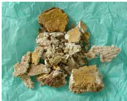
Сл. 6,1. Тенок бел малт̀ер жолт̀о обоен Fig. 6,1. Thin white mortar colored in yellow
